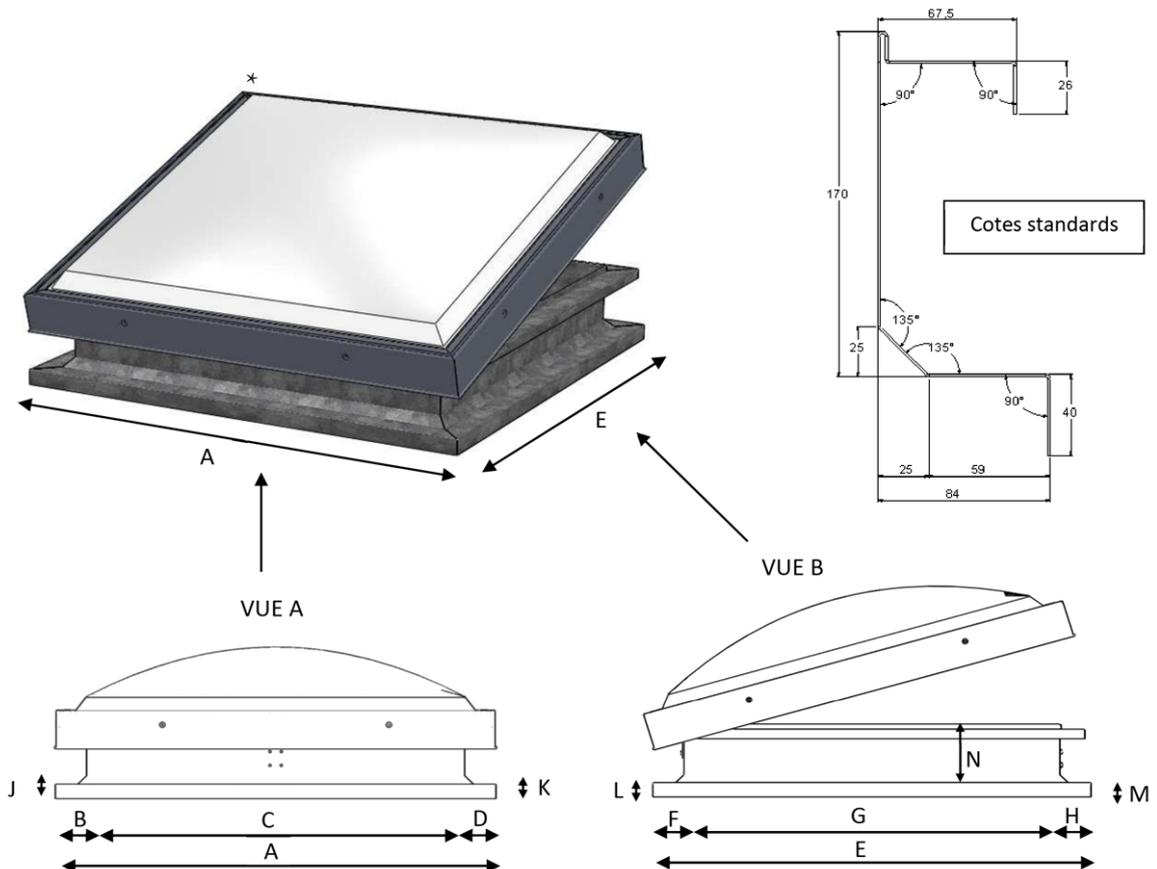
\* Vue d'un appareil ouvrant; les éléments à renseigner pour un appareil fixe sont identiques
